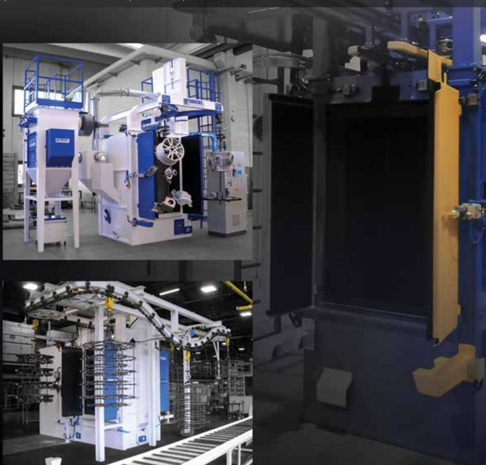
Impianto di granigliatura in continuo a tunnel, progettato per il trattamento di manufatti di medie/grandi dimensioni, movimentati da un trasportatore aereo di tipo a monorotaia, a bi-rotaia, o con paranchi, oppure da carrelli a terra.
